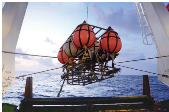
图7-11 多道地震气枪下水
